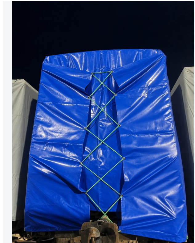
Cubierta, cerramiento y sistema de amarre.
